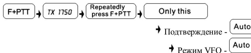
**23. Переключение частот приема/передачи при работе на разнесенных частотах (Cross-Band) --- Menu 23 (стр. 34)**
